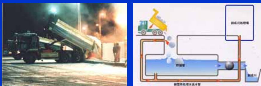
下水排熱による融雪システム
